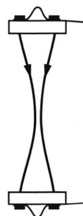
Опыт 2. Взаимодействие проводников при пропускании через них электрического тока I_2 > I_1 в одном направлении
