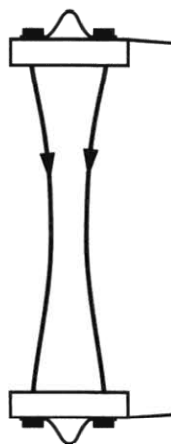
Опыт 1. Взаимодействие проводников при пропускании через них электрического тока I_1 в одном направлении
