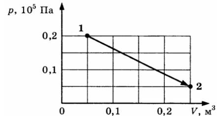
**429.** В каком из процессов перехода идеального газа из состояния 1 в состояние 2, изображенном на  $pV$ -диаграмме (см. рис.), газ совершает наибольшую работу?
