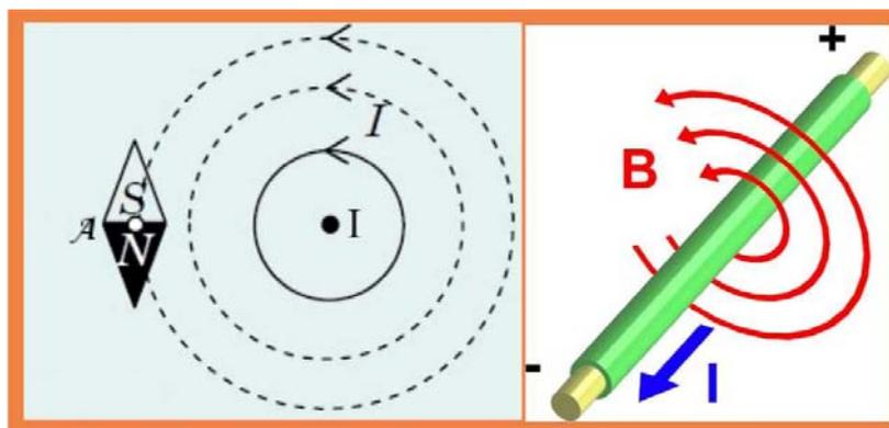
169. На рисунке изображен прямолинейный провод, подключенный к полюсам источника (см. рис.). Постройте линии магнитной индукции для этого тока и определите их направление.
