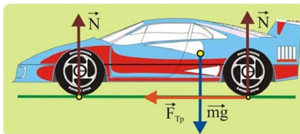
Система сил, действующих на автомобиль
