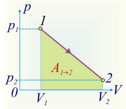
**428.** Какую работу совершил одноатомный газ в процессе, изображенном на  $pV$ -диаграмме?
