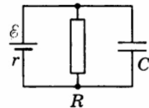
**637.** Найдите электрический заряд на конденсаторе емкостью  $C = 1 \text{ мФ}$  (см. рис.), если внутреннее сопротивление источника тока  $r = 2 \text{ Ом}$ , его ЭДС равна  $24 \text{ В}$ , сопротивление резистора  $R = 10 \text{ Ом}$ .
