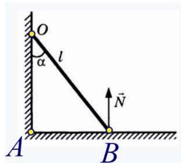
370. Однородная лестница массой  $m$  и длиной  $l$  опирается на стену, образуя с полом угол  $\alpha$  (см. рис.). Найдите момент силы трения  $F_{тр}$ , относительно точки  $O$ .
