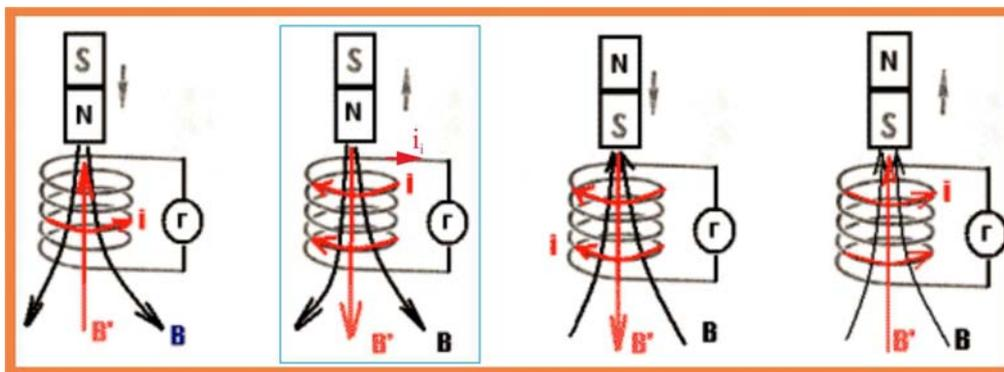
186. Катушка соединена с микроамперметром. Сверху к ней приближают электромагнит. Определите направление индукционного тока, возникающего в катушке.
