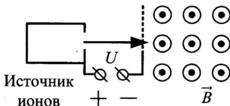
15. Ион ускоряется в электрическом поле с разностью потенциалов  $U = 10$  кВ и попадает в однородное магнитное поле перпендикулярно к вектору его индукции  $\vec{B}$  (см. рис.). Радиус траектории движения иона в магнитном поле  $R = 0,2$  м, отношение массы иона к его электрическому заряду  $\frac{m}{q} = 5 \cdot 10^{-7}$  кг/Кл. Определите значение модуля индукции магнитного поля. Кинетической энергией иона при его вылете из источника пренебрегите.
