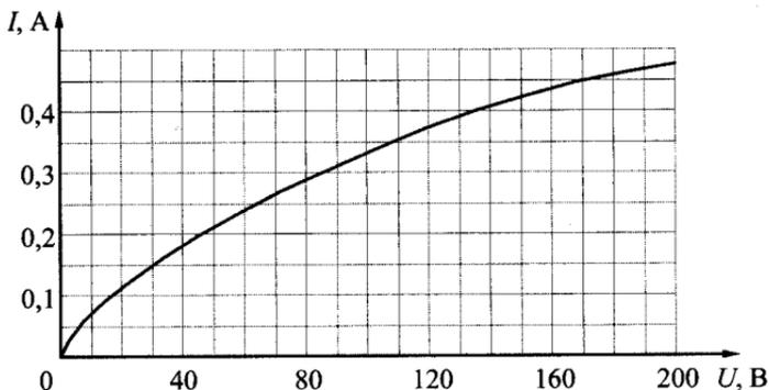
25. На рисунке изображена зависимость силы тока через лампу накаливания от приложенного к ней напряжения. При параллельном соединении двух таких ламп и источника сила тока в цепи оказалась равной  $0,7\text{ А}$ . Каково напряжение на клеммах источника? Внутренним сопротивлением источника пренебречь.
