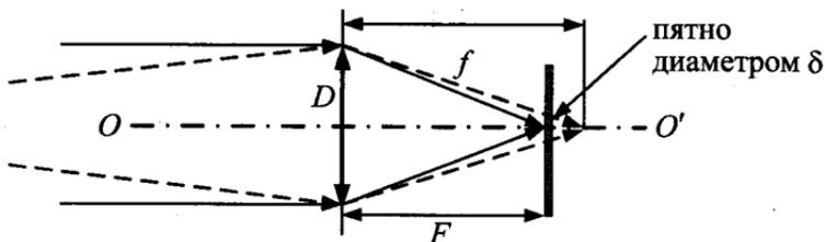
Лучи, идущие от предмета, находящегося на расстоянии  $d$ , собираются на расстоянии  $f$ , которое больше фокусного расстояния, и поэтому образуют на пленке пятно диаметром  $\delta$ . Из подобия треугольников получаем соотношение:
