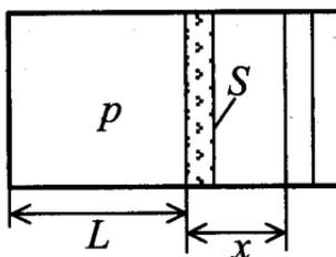
2. Поэтому при нагревании газа поршень будет неподвижен, пока давление газа не достигнет значения  $p_2$ . В этом процессе газ получает количество теплоты  $Q_{12}$ .
