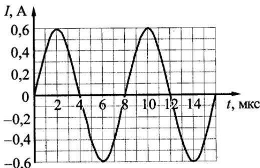
41. Сила тока в идеальном колебательном контуре меняется со временем так, как показано на рисунке. Определите заряд конденсатора в момент времени 7 мкс.
