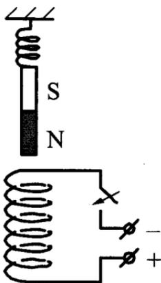
50. Непосредственно над неподвижно закрепленной проволочной катушкой вдоль ее оси на пружине подвешен полосовой магнит (см. рис.). Куда начнет двигаться магнит сразу после замыкания ключа? Ответ поясните, указав, какие физические явления и законы вы использовали для объяснения.
