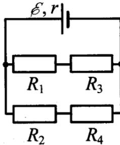
37. В схеме, изображенной на рисунке, сопротивления резисторов  $R_1 = 4 \text{ Ом}$ ,  $R_2 = 6 \text{ Ом}$ ,  $R_3 = 6 \text{ Ом}$ ,  $R_4 = 9 \text{ Ом}$ , ЭДС батареи  $\mathcal{E} = 20 \text{ В}$ , ее внутреннее сопротивление  $r = 2 \text{ Ом}$ . Определите мощность, выделяемую на резисторе  $R_2$ .
