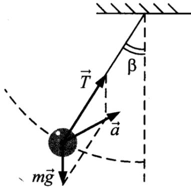
2. В промежуточной точке скорость шарика  $\vec{v} \neq 0$ , поэтому у шарика есть центростремительное ускорение  $\vec{a}_{\text{ц}} \neq 0$ , направленное к центру окружности, по которой движется шарик.
