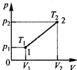
Температуру газа в состоянии 1 обозначим через  $T_1$ , а в состоянии 2 — через  $T_2$ .
