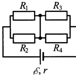
42. Какая тепловая мощность выделяется на лампе 4 в цепи, собранной по схеме, изображенной на рисунке? Сопротивление ламп 1 и 2  $R_1 = 20$  Ом, ламп 3 и 4  $R_2 = 10$  Ом. Внутреннее сопротивление источника  $r = 5$  Ом, его ЭДС  $\mathcal{E} = 100$  В.
