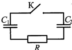
66. В электрической схеме, показанной на рисунке, ключ  $K$  замкнут. ЭДС батарейки  $\mathcal{E} = 24$  В, сопротивление резистора  $R = 25$  Ом, заряд конденсатора 2 мкКл. После размыкания ключа  $K$  в результате разряда конденсатора на резисторе выделяется количество теплоты 20 мкДж. Найдите внутреннее сопротивление батарейки  $r$ .
