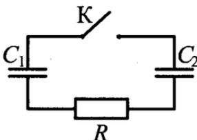
65. Заряженный конденсатор  $C_1 = 1$  мкФ включен в последовательную цепь из резистора  $R = 300$  Ом, незаряженного конденсатора  $C_2 = 2$  мкФ и разомкнутого ключа  $K$  (см. рис.). Какое количество теплоты выделяется в цепи после замыкания ключа, если первоначальное напряжение на конденсаторе  $C_1$  равно 300 В?
