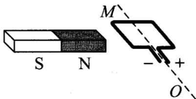
48. Рамку с постоянным током удерживают неподвижно в поле полосового магнита (см. рис.). Полярность подключения источника тока к выводам рамки показана на рисунке. Как будет двигаться рамка на неподвижной оси  $MO$ , если рамку не удерживать? Ответ поясните, указав, какие физические закономерности вы использовали для объяснения. Считать, что рамка испытывает небольшое сопротивление движению со стороны воздуха.
