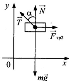
3. По условию задачи брусок покоится, поэтому выполнено условие его равновесия относительно поступательного движения. Запишем это условие в проекциях на оси системы координат:
