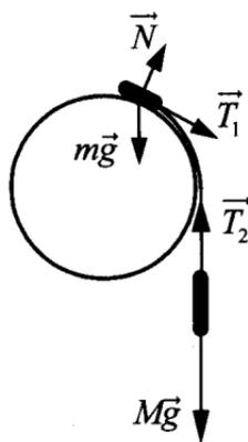
3. Таким образом, сумма работ всех непотенциальных сил, действующих на грузы  $m$  и  $M$ , равна нулю. Поэтому в инерциальной системе отсчета, связанной с Землей, механическая энергия системы этих грузов сохраняется.
