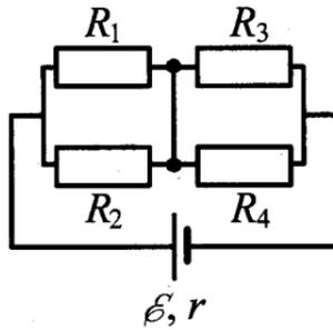
41. Какая тепловая мощность будет выделяться на резисторе  $R_3$  в схеме, изображенной на рисунке, если резистор  $R_4$  перегорит (превратится в разрыв цепи)? Все резисторы, включенные в схему, имеют одинаковое сопротивление 40 Ом. Внутреннее сопротивление источника  $r = 2$  Ом; его ЭДС 50 В.
