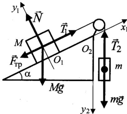
2. Будем считать систему отсчета, связанную с наклонной плоскостью, инерциальной. Запишем второй закон Ньютона для каждого из покоящихся тел в проекциях на оси введенной системы координат:
