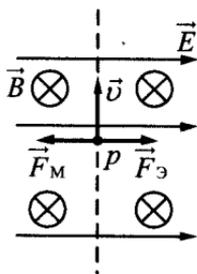
2. На протон действуют магнитное поле силой  $F_M = qvB$  и электрическое поле силой  $F_E = qE$ . Поскольку заряд протона положительный,  $\vec{F}_E$  сонаправлена с  $\vec{E}$ , а по правилу левой руки  $\vec{F}_M$  направлена противоположно силе  $\vec{F}_E$ .
