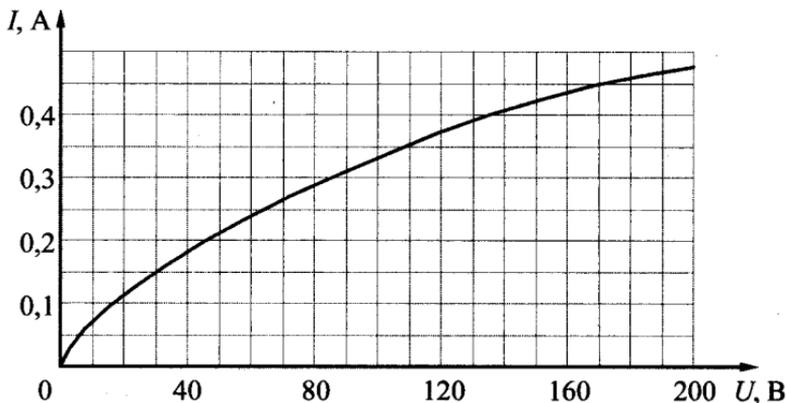
26. Вольт-амперная характеристика лампы накаливания изображена на рисунке. При напряжении источника  $12\text{ В}$  температура нити лампы равна  $3100\text{ К}$ . Сопротивление нити прямо пропорционально ее температуре. Какова температура нити накала при напряжении источника  $6\text{ В}$ ?
