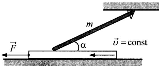
32. Однородный тонкий стержень массой  $m$  одним концом шарнирно прикреплен к потолку, а другим концом опирается на массивную горизонтальную доску, образуя с ней угол  $\alpha = 30^\circ$ . Под действием горизонтальной силы  $\vec{F}$  доска движется поступательно влево с постоянной скоростью (см. рис.). Стержень при этом неподвижен. Найдите  $m$ , если коэффициент трения стержня по доске  $\mu = 0,2$ , а сила  $F = 0,9$  Н. Трением доски по опоре и трением в шарнире пренебечь.
