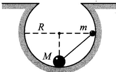
42. Небольшие шарики, массы которых  $m$  и  $M$ , соединены легким стержнем и помещены в гладкую сферическую выемку радиусом  $R = 20$  см. В начальный момент шарики удерживаются в положении, изображенном на рисунке. Когда их отпустили без толчка, шарики стали скользить по поверхности выемки. Минимальная высота, на которой оказался шарик  $m$  в процессе движения, равна 4 см от нижней точки выемки. Определите отношение масс  $M$  и  $m$ .
