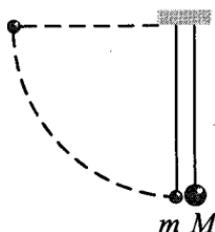
69. Два шарика висят, соприкасаясь, на вертикальных нитях (см. рис.). Левый шарик отклоняют на угол  $90^\circ$  и отпускают с начальной скоростью, равной нулю. Каким должно быть отношение масс шариков  $\frac{M}{m}$ , чтобы в результате их абсолютно неупругого удара половина кинетической энергии левого шарика, которой шарик обладал непосредственно перед ударом, перешла в тепло?
