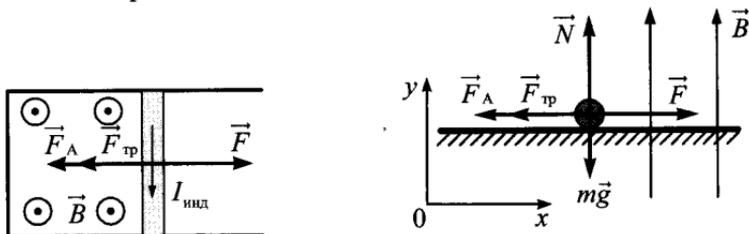
При движении перемычки в однородном магнитном поле на ее концах возникает ЭДС электромагнитной индукции:  $\mathcal{E} = Bvl$ , где  $B$  — индукция магнитного поля;  $v$  и  $l$  — соответственно скорость и длина перемычки. Согласно закону Ома для полной цепи в замкнутом контуре возникает индукционный ток:
