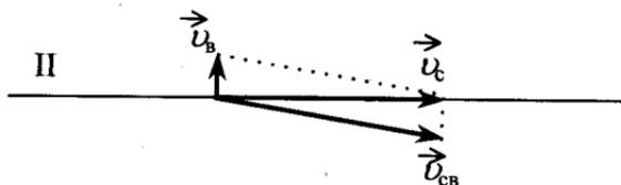
Выражение для скорости самолета относительно Земли во втором случае имеет вид:  $v_c = \sqrt{v_{CB}^2 - v_B^2}$ .
