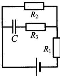
60. Источник постоянного тока с ЭДС  $\mathcal{E} = 10 \text{ В}$  и внутренним сопротивлением  $r = 0,4 \text{ Ом}$  подсоединен к параллельно соединенным резисторам  $R_1 = 4 \text{ Ом}$ ,  $R_2 = 6 \text{ Ом}$  и конденсатору. Определите емкость конденсатора  $C$ , если энергия электрического поля конденсатора равна  $W = 60 \text{ мкДж}$ .
