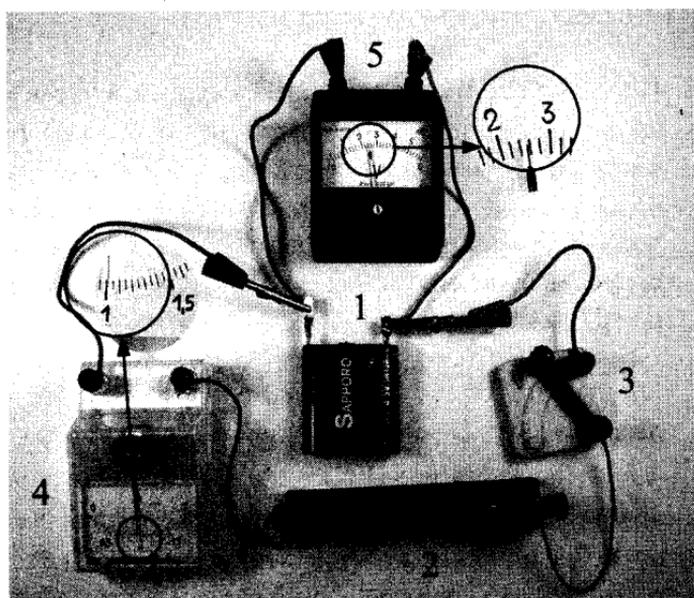
53. Ученик собрал электрическую цепь, состоящую из батарейки (1), реостата (2), ключа (3), амперметра (4) и вольтметра (5). После этого он измерил напряжение на полюсах источника тока и силу тока в цепи при различных положениях ползунка реостата (см. фотографии). Определите количество теплоты, выделяющееся внутри батарейки за 1 мин во втором опыте.
