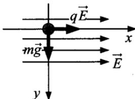
2. В инерциальной системе отсчета, связанной с Землей, в соответствии со вторым законом Ньютона, вектор ускорения тела пропорционален вектору суммы сил, действующих на него:  $m\vec{a} = \vec{F}_1 + \vec{F}_2$ .
