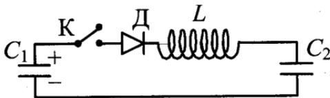
49. К конденсатору  $C_1 = 0,5$  мкФ через диод и катушку индуктивности  $L$  подключен конденсатор емкостью  $C_2$ . До замыкания ключа  $K$  конденсатор  $C_1$  был заряжен до напряжения  $U = 50$  В, а конденсатор  $C_2$  не заряжен. После замыкания ключа система перешла в новое состояние равновесия, в котором напряжение на конденсаторе  $C_2$  оказалось равным  $U_2 = 20$  В. Какова емкость конденсатора  $C_2$ ? (Активное сопротивление цепи пренебрежимо мало.)
