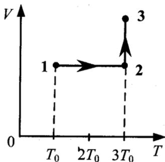
26. Один моль одноатомного идеального газа переходит из состояния 1 в состояние 3 в соответствии с графиком зависимости его объема  $V$  от температуры  $T$  ( $T_0 = 200$  К). На участке 1–2 к газу подводят 2,5 кДж теплоты. Найдите отношение работы газа  $A_{123}$  ко всему количеству подведенной к газу теплоты  $Q_{123}$ .
