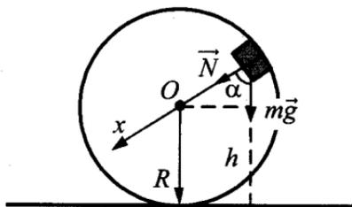
2. Когда кубик находится на высоте  $h$ , на него действуют две силы: сила тяжести  $m\vec{g}$  и сила реакции опоры  $\vec{N}$ . Запишем второй закон Ньютона в проекциях на радиальное направление ( $Ox$  на рисунке):  $mg \cos \alpha + N = \frac{mv^2}{R}$ , где  $\frac{v^2}{R} = a_n$  — центростремительное ускорение кубика в этой точке.
