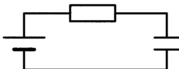
63. Источник постоянного напряжения с ЭДС 100 В подключен через резистор к конденсатору переменной емкости, расстояние между пластинами которого можно изменять (см. рис.). Пластины медленно раздвинули. Какое количество теплоты выделилось за время движения пластин на резисторе, если против сил притяжения пластин была совершена работа 60 мкДж и заряд конденсатора изменился на 1 мкКл?
