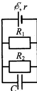
61. Источник постоянного тока с внутренним сопротивлением  $r = 0,4 \text{ Ом}$  подсоединен к параллельно соединенным резисторам  $R_1 = 10 \text{ Ом}$ ,  $R_2 = 2 \text{ Ом}$  и конденсатору емкости  $C = 5 \text{ мкФ}$ . Определите ЭДС источника  $\mathcal{E}$ , если энергия электрического поля конденсатора  $W = 10 \text{ мкДж}$ .
