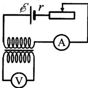
57. На рисунке изображены две изолированные друг от друга электрические цепи. Первая содержит последовательно соединенные источник тока, реостат, катушку индуктивности и амперметр, а вторая — проволочный моток, к концам которого присоединен гальванометр, изображенный на рисунке справа. Катушка и моток надеты на железный сердечник.
