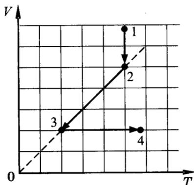
6. На  $VT$ -диаграмме показано, как изменялись объем и температура некоторого постоянного количества разреженного газа при его переходе из начального состояния 1 в состояние 4. Как изменялось давление газа  $p$  на каждом из трех участков 1–2, 2–3, 3–4: увеличивалось, уменьшалось или же оставалось неизменным? Ответ поясните, указав, какие физические явления и закономерности вы использовали для объяснения.
