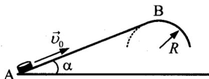
36. Небольшая шайба после удара скользит вверх по наклонной плоскости из точки А (см. рис.). В точке В наклонная плоскость без излома переходит в наружную поверхность горизонтальной трубы радиусом  $R = 0,3$  м. Если в точке А скорость шайбы превосходит  $v_0 = 4$  м/с, то в точке В шайба отрывается от опоры. Длина наклонной плоскости  $AB = L$ , угол  $\alpha = 30^\circ$ . Коэффициент трения между наклонной плоскостью и шайбой  $\mu = 0,2$ . Найдите длину наклонной плоскости  $L$ .
