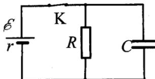
67. В электрической схеме, показанной на рисунке, ключ  $K$  замкнут. ЭДС батарейки  $\mathcal{E} = 12$  В, емкость конденсатора  $C = 0,2$  мкФ. После размыкания ключа  $K$  в результате разряда конденсатора на резисторе выделяется количество теплоты  $Q = 10$  мкДж. Найдите отношение внутреннего сопротивления батарейки к сопротивлению резистора  $\frac{r}{R}$ .
