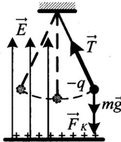
2. Протяженная равномерно заряженная пластина создает однородное электрическое поле  $\vec{E}$ . Если шарiku сообщить отрицательный заряд, то со стороны электрического поля пластины на него начнет действовать постоянная сила Кулона, равная по величине  $F_K = Eq$  и направленная вертикально вниз (см. рис.).
