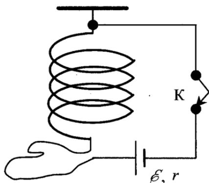
46. Мягкая пружина из нескольких крупных витков провода подвешена к потолку. Верхний конец пружины подключается к источнику тока через ключ  $K$ , а нижний — с помощью достаточно длинного мягкого провода (см. рис.). В начальный момент ключ замкнут. Как изменится длина пружины через достаточно большое время после размыкания ключа  $K$ ? Ответ поясните, указав, какие физические явления и закономерности вы использовали для объяснения.
