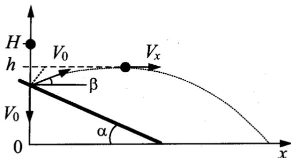
2. При движении после соударения горизонтальная составляющая скорости не изменяется, так как шарик находится в свободном падении, а сила тяжести направлена вертикально, т. е.  $v_x = V_0 \cos \beta = \text{const}$ .
