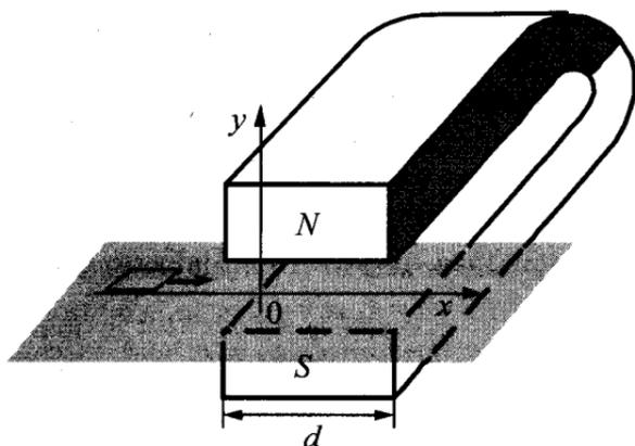
22. Горизонтальный проводник длиной 1 м движется равноускоренно в вертикальном однородном магнитном поле, индукция которого направлена перпендикулярно проводнику и скорости его движения (см. рис.). При начальной скорости проводника, равной нулю, и ускорении  $8$  м/с<sup>2</sup>, он переместился на 1 м. Какова индукция магнитного поля, в котором двигался проводник, если ЭДС индукции на концах проводника в конце движения равна 2 В?
