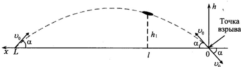
При отсутствии сопротивления воздуха траектория снаряда — парабола, и в точке падения на Землю снаряд должен иметь ту же по модулю скорость  $v_0$ , составляющую с горизонталью тот же угол  $\alpha$ , что и в точке вылета. Поэтому если из точки взрыва выпустить воображаемый снаряд обратно со скоростью  $\vec{v}_0$ , направленной под углом  $\alpha$  к горизонту, то он полетит по той же траектории и упадет на пушку (см. рис.).
