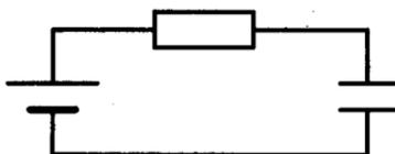
64. Заряженный конденсатор  $C_1 = 1$  мкФ включен в последовательную цепь из резистора  $R = 300$  Ом, незаряженного конденсатора  $C_2 = 2$  мкФ и разомкнутого ключа К (см. рис.). После замыкания ключа в цепи выделяется количество теплоты  $Q = 30$  мДж. Чему равно первоначальное напряжение на конденсаторе  $C_1$ ?
