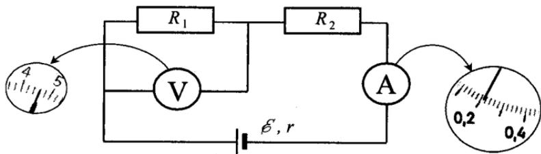
31. При проведении лабораторной работы ученик собрал электрическую цепь по схеме на рисунке. Сопротивления  $R_1$  и  $R_2$  равны 20 Ом и 150 Ом соответственно. Сопротивление вольтметра равно 10 кОм, а амперметра — 0,4 Ом. ЭДС источника равна 36 В, а его внутреннее сопротивление — 6 Ом.
