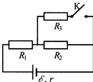
49. В электрической цепи, схема которой изображена на рисунке, ключ  $K$  первоначально замкнут. Во сколько раз изменится мощность, выделяемая на резисторе  $R_1$ , при размыкании ключа  $K$ , если  $R_1 = R_2 = R_3 = 1 \text{ Ом}$ ,  $r = 0,5 \text{ Ом}$ ?
