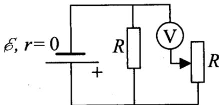
40. В схеме на рисунке сопротивление резистора и полное сопротивление реостата равны  $R$ , ЭДС батарейки равна  $\mathcal{E}$ , ее внутреннее сопротивление ничтожно ( $r = 0$ ). Как ведут себя (увеличиваются, уменьшаются, остаются постоянными) показания идеального вольтметра при перемещении движка реостата из крайнего верхнего в крайнее нижнее положение? Ответ поясните, указав, какие физические закономерности вы использовали для объяснения.
