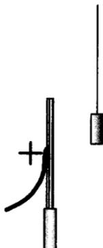
26. Около небольшой металлической пластины, укрепленной на изолирующей подставке, подвесили на шелковой нити легкую металлическую незаряженную гильзу. Когда пластину подсоединили к клемме высоковольтного выпрямителя, подав на нее отрицательный заряд, гильза пришла в движение. Опишите движение гильзы и объясните его.
