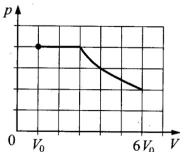
1. На участке от  $V_0$  до  $3V_0$  давление под поршнем постоянно (давление насыщенного пара на изотерме). На участке от  $3V_0$  до  $6V_0$  давление под поршнем подчиняется закону Бойля–Мариотта.
