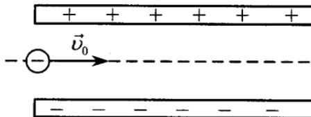
12. На рисунке показана схема устройства для предварительного отбора заряженных частиц для последующего детального исследования. Устройство представляет собой конденсатор, пластины которого изогнуты дугой радиуса  $R \approx 50$  см. Предположим, что в промежуток между обкладками конденсатора из источника заряженных частиц (и.ч.) влетают ионы с зарядом  $-e$ , как показано на рисунке. Напряженность электрического
