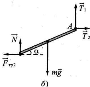
3. По условию задачи стержень покоится, поэтому сумма моментов сил, действующих на шар, относительно оси шарнира  $A$  равна нулю. Обозначив длину стержня через  $L$ , запишем это условие:
