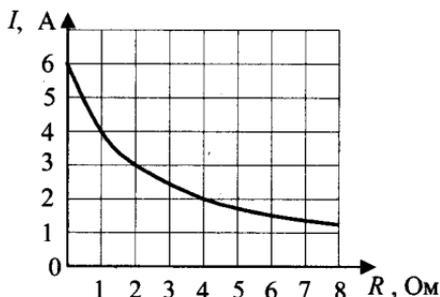
39. Реостат  $R$  подключен к источнику тока с ЭДС  $\mathcal{E}$  и внутренним сопротивлением  $r$  (см. рис.). Зависимость силы тока в цепи от сопротивления реостата представлена на графике. Найдите сопротивление реостата, при котором мощность тока, выделяемая на внутреннем сопротивлении источника, равна 18 Вт.
