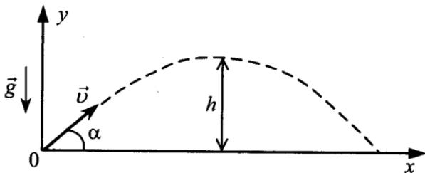
Модель гонщика — материальная точка. Считаем полет свободным падением с начальной скоростью  $v$ , направленной под углом  $\alpha$  к горизонту. Дальность полета при этом  $S = vt \cos \alpha$ , время полета  $t = \frac{2v \sin \alpha}{g}$ . Следовательно,  $S = 2 \frac{v^2}{g} \sin \alpha \cos \alpha$ .
