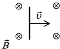
23. Горизонтальный проводник движется равноускоренно в вертикальном однородном магнитном поле, индукция которого равна 0,5 Тл и направлена перпендикулярно проводнику и скорости его движения (см. рис.). При начальной скорости проводника, равной нулю, и ускорении  $8 \text{ м/с}^2$ , проводник переместился на 1 м. ЭДС индукции на концах проводника в конце движения равна 2 В. Какова длина проводника?
