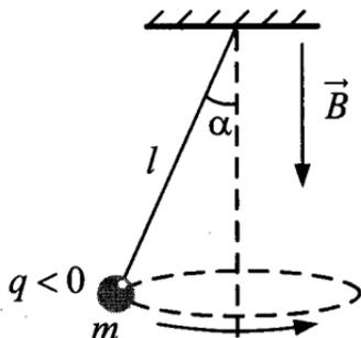
17. В однородном магнитном поле с индукцией  $\vec{B}$ , направленной вертикально вниз, равномерно вращается по окружности в горизонтальной плоскости против часовой стрелки положительно заряженный шарик, подвешенный на нити длиной  $l$  (конический маятник). Заряд шарика  $q$ , скорость его вращения  $v$ . Угол отклонения нити от вертикали равен  $\alpha$ . Найдите массу шарика. Сделайте рисунок с указанием сил, действующих на шарик.
