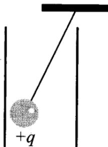
16. Полый металлический шарик массой 2 г подвешен на шелковой нити длиной 50 см. Шарик имеет положительный заряд  $10^{-8}$  Кл и находится в однородном электрическом поле напряженностью  $10^6$  В/м, направленном вертикально вниз. Каков период малых колебаний шарика?
