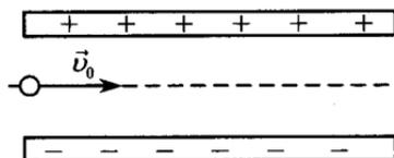
9. Электрон влетает в плоский конденсатор со скоростью  $v_0$  ( $v_0 \ll c$ ), параллельно пластинам (см. рис.), расстояние между которыми  $d$ . Какова разность потенциалов между пластинами конденсатора, если при вылете из конденсатора вектор скорости электрона отклоняется от первоначального направления на угол  $\alpha$ ? Длина пластин  $L$  ( $L \gg d$ ). Поле внутри конденсатора считать однородным, силой тяжести пренебречь. Система находится в вакууме.
