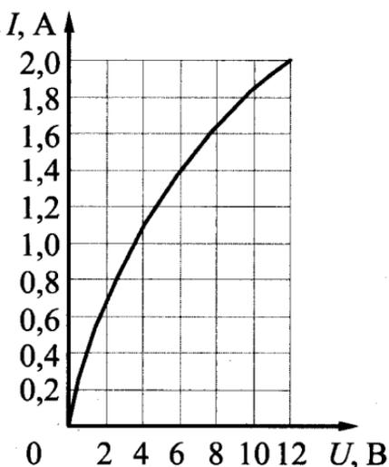
27. Вольт-амперная характеристика лампы накаливания изображена на рисунке. При напряжении источника 6 В температура нити лампы равна 2210 К. Сопротивление нити прямо пропорционально ее температуре. Какова температура нити накала при напряжении источника 12 В?
