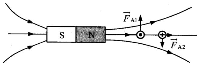
3. Рамка устанавливается перпендикулярно оси магнита так, что контакт «+» оказывается внизу. При этом силы Ампера  $\vec{F}_{A1}$  и  $\vec{F}_{A2}$  обеспечивают равновесие рамки на оси  $MO$  (см. рис.).
