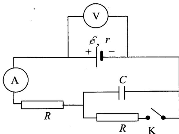
44. На рисунке показана электрическая цепь, содержащая источник тока (с внутренним сопротивлением), два резистора, конденсатор, ключ  $K$ , а также амперметр и идеальный вольтметр. В начальный момент ключ замкнут. Как изменятся показания
