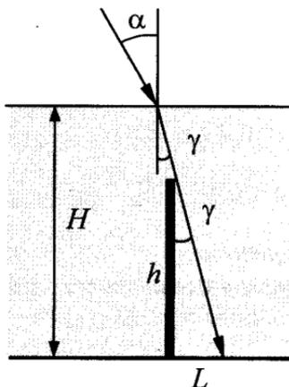
Согласно рисунку, длина тени  $L$  определяется высотой сваи  $h$  и углом  $\gamma$  между свайей и скользящим по ее вершине лучом света:  $L = h \cdot \operatorname{tg} \gamma$ . Этот угол является и углом преломления солнечных лучей на поверхности воды. Согласно закону преломления,
