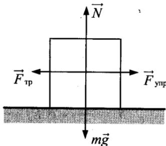
$$kb = \max F_{\text{тр. покоя}} = \mu N = \mu mg. \text{ Отсюда } b = \frac{\mu mg}{k}.$$
