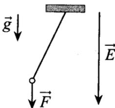
$$\vec{F} = \vec{F}_{\text{грав.}} + \vec{F}_{\text{эл.}}, \text{ где } \vec{F}_{\text{грав.}} = m\vec{g} \text{ и } \vec{F}_{\text{эл.}} = q\vec{E}. \text{ Так как } \vec{g} \uparrow \uparrow \vec{E}, \text{ то}$$
