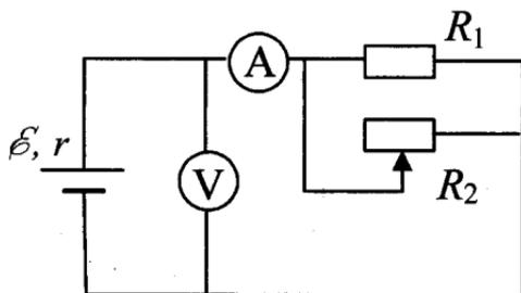
36. На рисунке показана принципиальная схема электрической цепи, состоящей из источника тока с отличным от нуля внутренним сопротивлением, резистора, реостата и измерительных приборов — идеального амперметра и идеального вольтметра. Используя законы постоянного тока, проанализируйте эту схему и выясните, как будут изменяться показания приборов при перемещении движка реостата *влево*.
