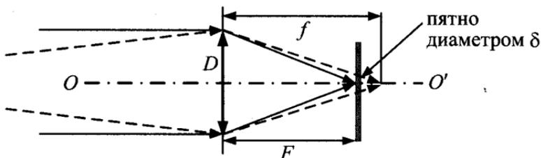
Лучи, идущие от предмета, находящегося на расстоянии  $d$ , собираются на расстоянии  $f$ , которое больше фокусного расстояния, и поэтому образуют на пленке пятно диаметром  $\delta$ . Из подобия треугольников получаем соотношение:  $\frac{\delta}{D} = \frac{f - F}{f}$ , а
