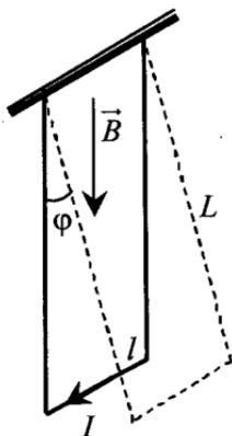
10. Металлический стержень длиной  $l = 0,1$  м и массой  $m = 10$  г, подвешенный на двух параллельных проводящих нитях длиной  $L = 1$  м, располагается горизонтально в однородном магнитном поле с индукцией  $B = 0,1$  Тл. Вектор магнитной индукции направлен вертикально. По стержню пропускают ток в течение 0,1 с, в результате чего стержень приобретает кинетическую энергию 0,005 Дж. Чему равна сила тока? Угол отклонения нитей от вертикали за время протекания тока мал (см. рис.).
