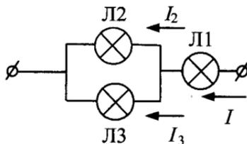
1. Напряжение на концах цепи из последовательно соединенных участков равно сумме напряжений на участках:
