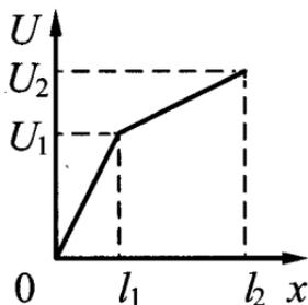
34. Цилиндрический проводник длиной  $l = l_2$  включен в цепь постоянного тока. К нему подключают вольтметр таким образом, что одна из клемм вольтметра все время подключена к началу проводника, а вторая может перемещаться вдоль проводника. На рисунке приведена зависимость показаний вольтметра  $U$  от расстояния  $x$  до начала проводника. Как зависит от  $x$  удельное сопротивление проводника? Ответ поясните, указав, какие физические закономерности вы использовали.
