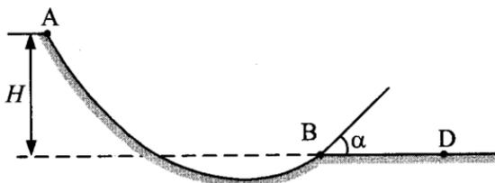
40. Массивная шайба начинает движение по желобу АВ из точки А из состояния покоя. Точка А расположена выше точки В на высоте  $H = 6$  м. В процессе движения по желобу механическая энергия шайбы из-за трения уменьшается на  $\Delta E = 2$  Дж. В точке В шайба вылетает из желоба под углом  $\alpha = 15^\circ$  к горизонту и падает на землю в точке D, находящейся на одной горизонтали с точкой В (см. рис.). Найдите массу шайбы, если  $BD = 2$  м. Сопротивлением воздуха пренебречь.
