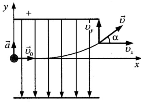
2. Уравнения для проекций скорости  $v_x = v_0$ ;  $v_y = at$ .
