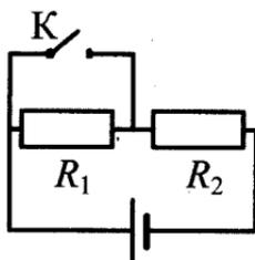
35. Источник тока, два резистора и ключ включены в цепь, как показано на рисунке. При разомкнутом ключе на резисторе  $R_1$  выделяется мощность 1 Вт, а на резисторе  $R_2$  — мощность 2 Вт. Какая мощность будет выделяться на резисторе  $R_2$  после замыкания ключа К? Внутренним сопротивлением источника пренебречь.
