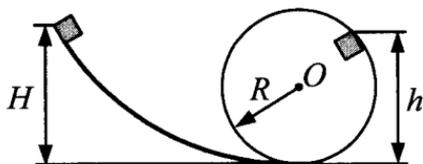
63. Небольшой кубик массой  $m = 1$  кг начинает соскальзывать с высоты  $H$  по гладкой горке, переходящей в мертвую петлю радиусом  $R = 2,5$  м (см. рис.). Определите высоту  $H$ , если на высоте  $h = 2,5$  м от нижней точки петли кубик давит на ее стенку с силой  $F = 4$  Н. Сделайте рисунок с указанием сил, поясняющий решение.
