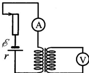
56. На рисунке приведена электрическая цепь, состоящая из гальванического элемента, реостата, трансформатора, амперметра и вольтметра. В начальный момент времени ползунок реостата
