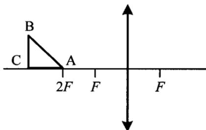
59. Равнобедренный прямоугольный треугольник ABC расположен перед тонкой собирающей линзой оптической силой 2,5 дптр так, что его катет AC лежит на главной оптической оси линзы (см. рис.). Вершина прямого угла C лежит ближе к центру линзы, чем вершина острого угла A. Расстояние от центра линзы до точки A равно удвоенному фокусному расстоянию линзы,  $AC = 4$  см. Постройте изображение треугольника и найдите площадь получившейся фигуры.
