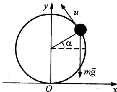
При этой скорости ее центростремительное ускорение  $a_{\text{ис}} = \frac{u^2}{R}$  в инерциальной системе отсчета  $Oxy$ , связанной с Землей, в соответствии со вторым законом Ньютона обеспе-
