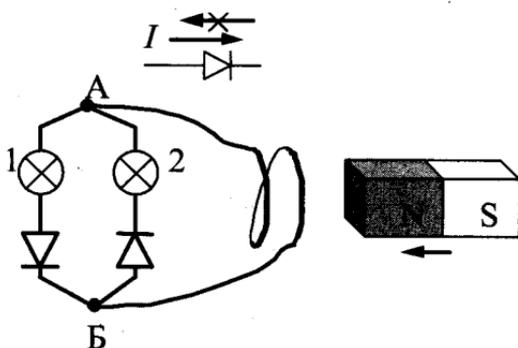
52. Электрическая цепь состоит из двух лампочек, двух диодов и витка провода, соединенных, как показано на рисунке. (Диод пропускает ток только в одном направлении, как показано в верхней части рисунка.) Какая из лампочек загорится, если отодвигать от витка северный полюс магнита? Ответ объясните, указав, какие физические явления и закономерности вы использовали для объяснения.
