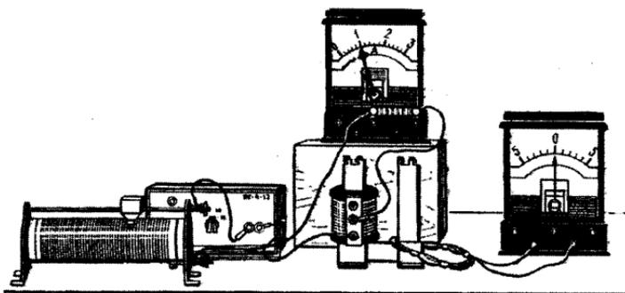
Как будут изменяться показания приборов, если проволочный моток, присоединенный к гальванометру, плавно перемещая вверх, снять с сердечника? Ответ поясните, указав, какие физические закономерности вы использовали для объяснения.
