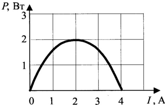
Используя известные физические законы, объясните, почему данный график зависимости мощности от силы тока является параболой. Чему равна ЭДС батареи?
