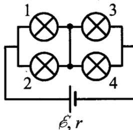
43. Какая тепловая мощность выделяется на лампе 2 в цепи, собранной по схеме, изображенной на рисунке? Сопротивление ламп 1 и 2  $R_1 = 20$  Ом, ламп 3 и 4  $R_2 = 10$  Ом. Внутреннее сопротивление источника  $r = 5$  Ом, его ЭДС  $\mathcal{E} = 100$  В.
