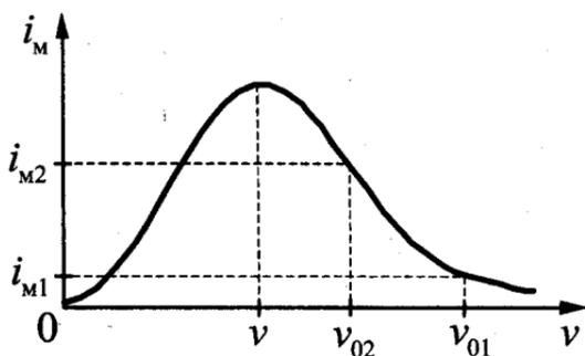
2. Таким образом, ученик, увеличивая емкость конденсатора от  $C_{\min}$  до  $C_{\max}$ , уменьшал собственную частоту колебаний контура от  $\nu_{01}$  до  $\nu_{02}$ , что привело к возрастанию амплитуды тока от  $i_{M1}$  до  $i_{M2}$  в соответствии с резонансной кривой.
