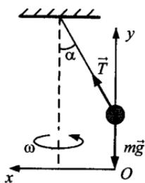
На груз действуют сила натяжения нити  $\vec{T}$  и сила тяжести  $m\vec{g}$ , как указано на рисунке. В инерциальной системе отсчета, связанной с Землей, ускорение тела определяется вторым законом Ньютона, что приводит к уравнениям для проекций сил и ускорений на оси  $OX$  и  $OY$ :
