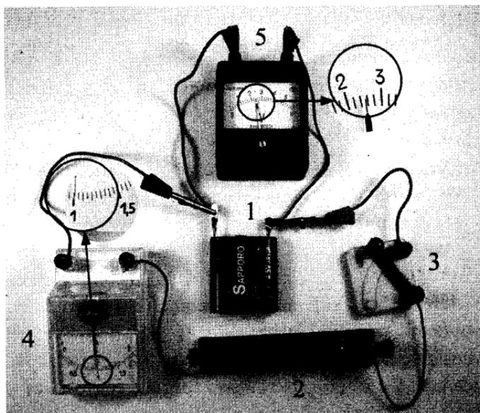
54. На фотографии представлена установка, в которой электродвигатель (1) с помощью нити (2) равномерно перемещает каретку (3) вдоль направляющей горизонтальной линейки. При прохождении каретки мимо датчика А секундомер (4) включается, а при прохождении каретки мимо датчика В секундомер выключается.
