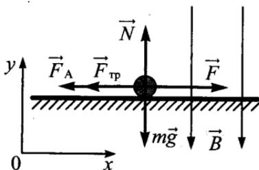
При движении перемычки в однородном магнитном поле на ее концах возникает ЭДС электромагнитной индукции:  $\mathcal{E} = BVl$ , где  $B$  — индукция магнитного поля;  $V$  и  $l$  — соответственно скорость и длина перемычки. Согласно закону Ома для полной цепи в замкнутом контуре возникает индукционный ток:
