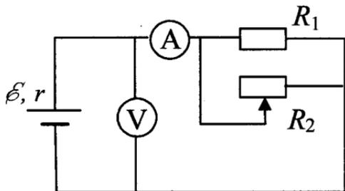
37. На фотографии изображена электрическая цепь, состоящая из резистора, реостата, ключа, цифровых вольтметра, подключенного к батарее, и амперметра.
