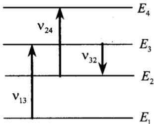
8. На рисунке представлены энергетические уровни атома и указаны частоты фотонов, излучаемых и поглощаемых при некоторых переходах между ними. Какова максимальная длина волны фотонов, излучаемых атомом при любых возможных переходах между уровнями  $E_1, E_2, E_3$  и  $E_4$ , если  $\nu_{13} = 7 \cdot 10^{14}$  Гц,  $\nu_{24} = 5 \cdot 10^{14}$  Гц,  $\nu_{32} = 3 \cdot 10^{14}$  Гц?
