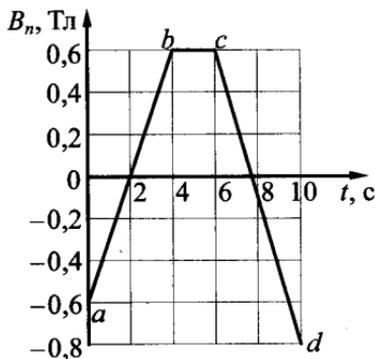
35. Квадратная проволочная рамка со стороной  $l = 10$  см находится в однородном магнитном поле с индукцией  $\vec{B}$ . На рисунке изображено изменение проекции вектора  $\vec{B}$  на перпендикуляр к плоскости рамки с течением времени. За время  $t = 10$  с в рамке выделяется количество теплоты  $Q = 0,1$  мДж. Каково сопротивление проволоки, из которой сделана рамка?
