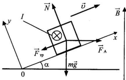
2. Силы, действующие на проводник, показаны на рисунке. Считая систему отсчета, связанную с наклонной плоскостью, инерциальной, запишем второй закон Ньютона в проекциях на оси  $Ox$  и  $Oy$  (см. рис.):
