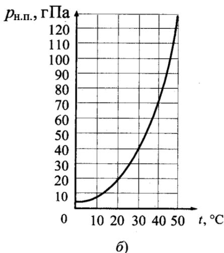
20. В опыте, иллюстрирующем зависимость температуры кипения от давления воздуха (рис. а), кипение воды под колоколом воздушного насоса происходит уже при комнатной температуре, если давление достаточно мало. Используя график зави-
